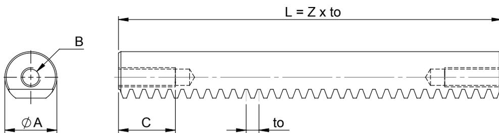
**!** Die Zahnstange ist symmetrisch gefertigt. Bei der Verwendung eines Zahnstangenschutzes verlängert sich die Zahnstange entsprechend. Lassen Sie sich die theoretische Lebensdauer berechnen.
